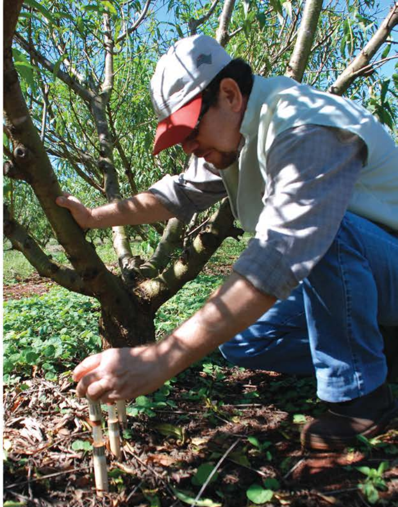
Nos pessegueiros, os tensiômetros instalados são digitais
